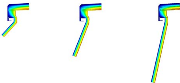
TopSky auf einem Pol.E15 Aufsatzkranz TopSky auf einem Pol.E30 Aufsatzkranz TopSky auf einem Pol.E50 Aufsatzkranz
